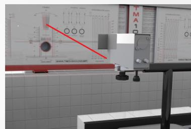
03. Com a chave allen 2,5 mm ajuste o parafuso número 1 para o ponto laser, fique exatamente na metade do deslocamento verificada na escala de deformação recoloca o projetor como indicado na figura 03 e confira se o ponto laser coincide com o valor anterior, ou seja, nas duas posições o ponto tem que incidir no mesmo número, caso isso não ocorra, refaça o procedimento, quando o ponto laser coincidir, o projetor estará calibrado.
