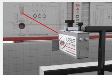
02. Retire o projetor e recoloca invertido, ou seja, com a parte de baixo virado para cima. Observe o ponto laser, ele deverá incidir no traço "0" (zero), caso isso não ocorra, o ponto laser deverá ser ajustado conforme descrito no item 3.
