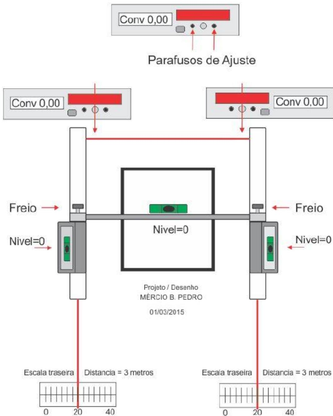
Ajuste o laser (nº 20) da escala, Depois gire o equipamento de cabeça para baixo e confira se o ajuste se mantém no nº 20
